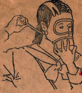
(5) 右手デ頭紐ノ交叉部ヲ後頭部ニ當テガヒ左手デ吸收函ヲ支ヘ覆面ヲ顔ニ合ハセ
